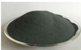
Por su reducido tamaño, la microsilice ocupa fácilmente los espacios generados entre las partículas de cemento, generando unidades de silicatos de calcio (2° cemento) como resultado de la reacción con el hidróxido de calcio generado durante el proceso de hidratación del cemento en el concreto fresco.
